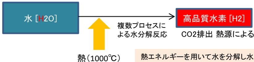
熱エネルギーを用いて水を分解し水素と酸素を製造する。水を直接に熱分解するには4000度以上の高温を必要とするが、熱化学水素製造法では複数の化学反応を組み合わせた化学プロセスによって、これより低温(1000°C以下)の熱を用いて水分解を行う。プロセスを構成する化学反応(以下、要素反応とよぶ)には、加水分解反応、水素発生反応、酸素発生反応などが用いられ、プロセス全体として、水の分解反応のみが正味の化学変化となるように構成される。
