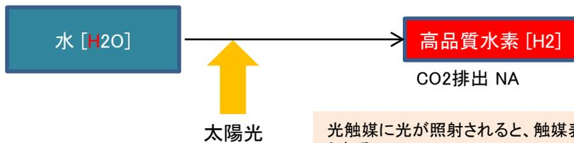
光触媒に光が照射されると、触媒表面に電子と正孔が生成し、この電子が水の水素イオンを還元することで水素が得られる
